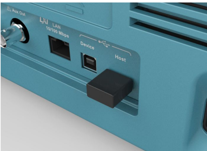
Обеспечивающие надежное беспроводное соединение адаптеры Wi-Fi настраиваются с помощью встроенных меню
